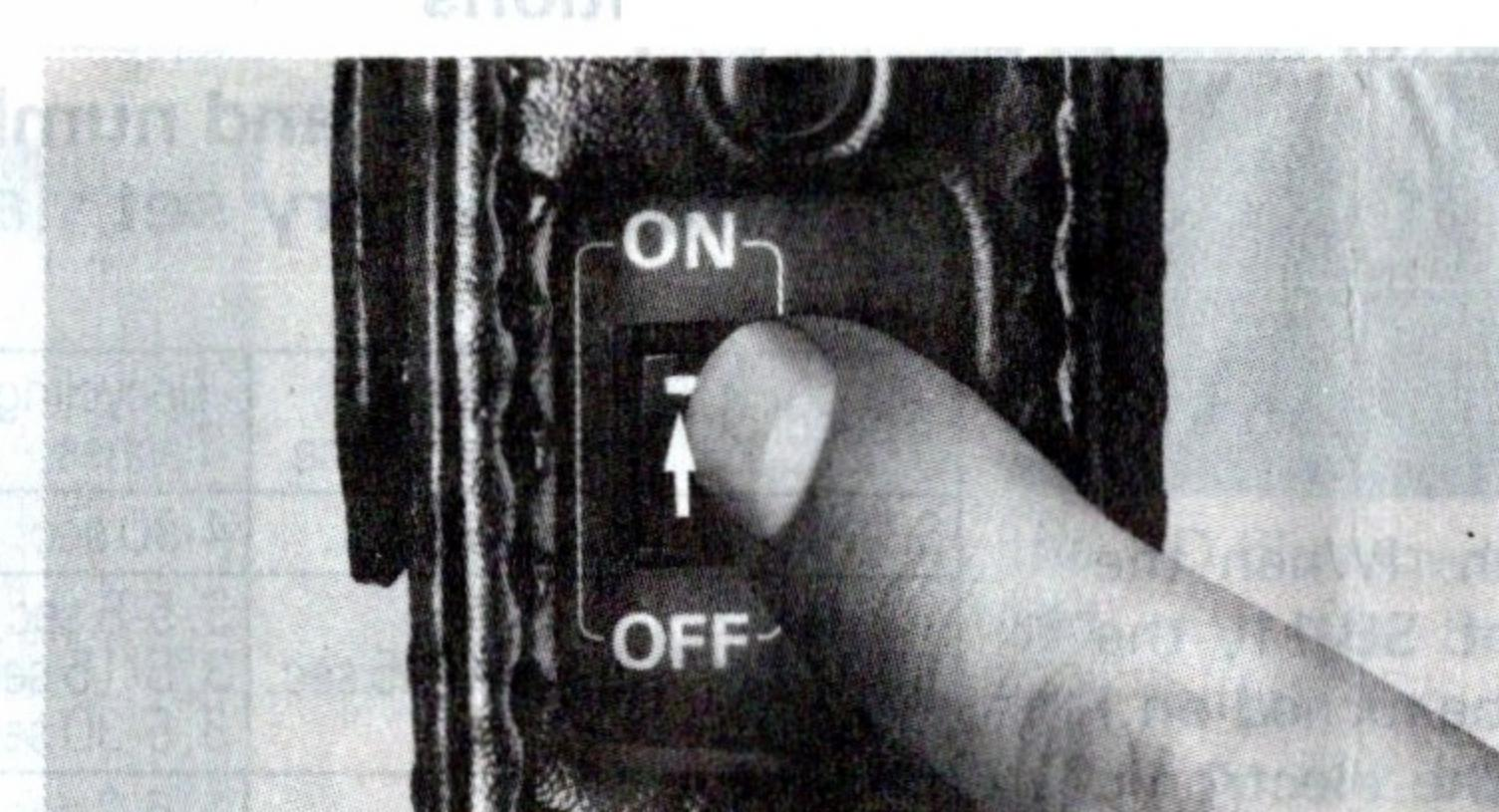
(5)電源スイッチをONにします。(SB-11を使用している場合はさらにスピードライト側のスイッチをONにします。)まもなくスピードライトのレディライトが点灯して、撮影準備が完了したことを示します。
