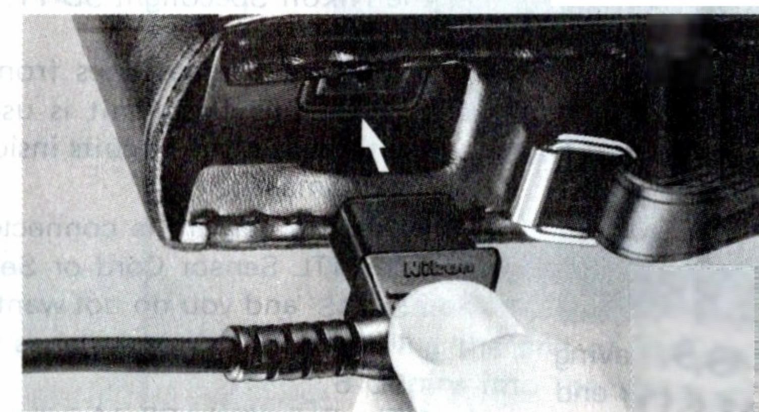
(4)電源コードSC-16の3ピンプラグをSD-6のコンセントに、3穴のプラグをスピードライトの外部電源コンセントに差し込みます。この時、コンセントの向きにご注意ください。
