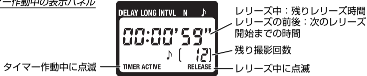
タイマー作動中の表示パネル
